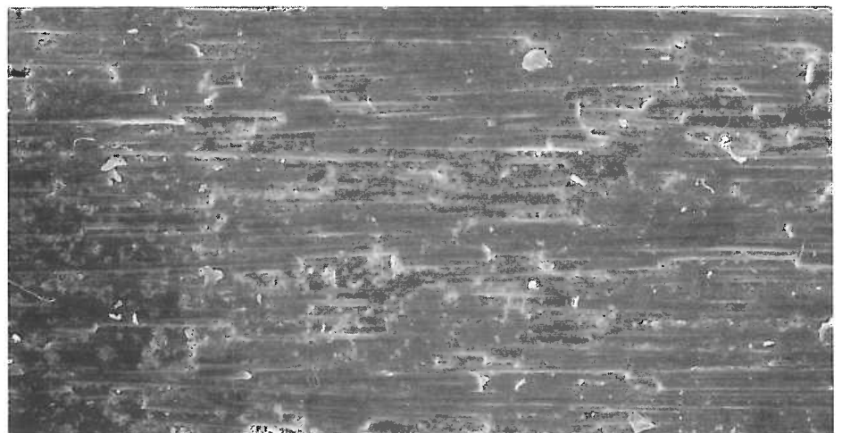
Samma yta PMB-behandlad. Vävavtrycken från tillverkningen har försvunnit – ( R_a ca 3 \mu\text{m} ).
