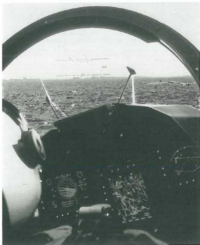
Fig 1. Gripens presentationssystem är baserad på elektronisk presentation med fyra indikatorer varav en siktlinjesindikator. Systemet ersätter helt konventionella flyginstrument.
